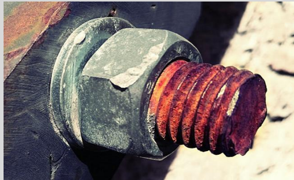
نمونه ای از خوردگی گالوانیک در متریال استنلس استیل
