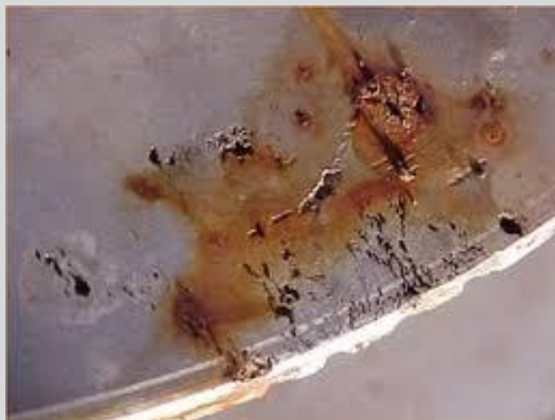
نمونه ای از خوردگی حفره ای ناشی از کلراید
