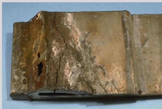
نمونه ای از ترک خوردگی تنشی (SCC)
