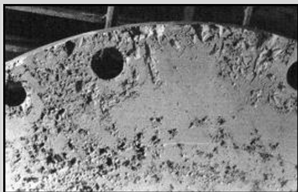
نمونه ای از خوردگی حفره ای در متریال استنلس استیل
