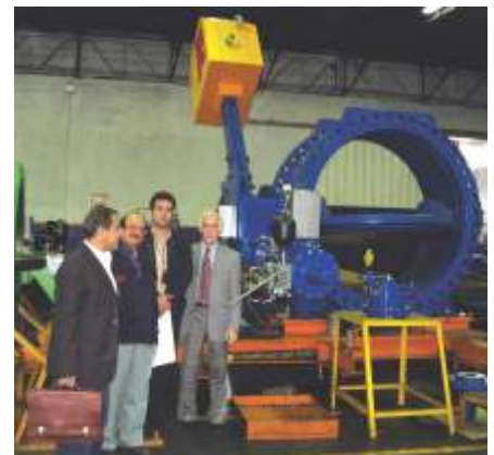
شیر سایز 1800 فشار 25 بار - نرمال باز کاربرد: شکستگی خط پروژه: سد آیدوغموش آذربایجان شرقی
