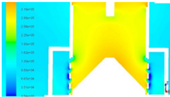
شکل (۱۵) توزیع فشار در صفحه تقارن شیر غلافی مجهز به صفحه سوراخ دار در دبی ۳۰ (الف) با قطر سوراخ ۱۵۰ (ب) با قطر سوراخ ۱۲۵ (ج) با قطر سوراخ ۱۰۰ (د) با قطر سوراخ ۷۰ میلی‌متر
